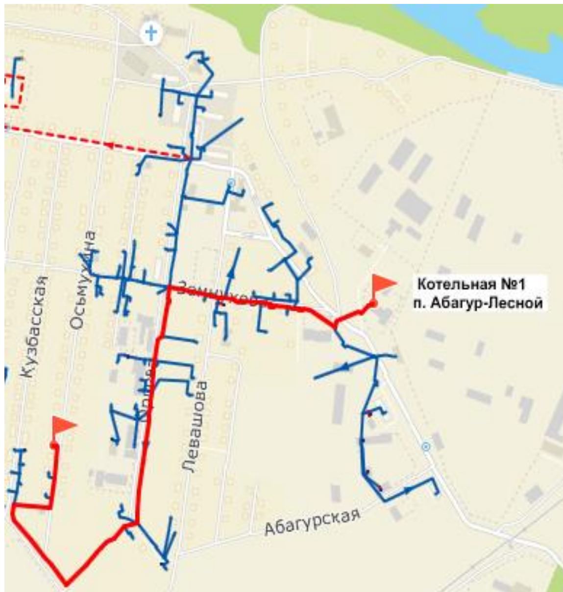
Рисунок 4.62 – Путь движения теплоносителя от источника тепловой энергии до конечного потребителя, в зоне действия котельной №1 п. Абагур-Лесной (рисунок П46.1 МУ)
