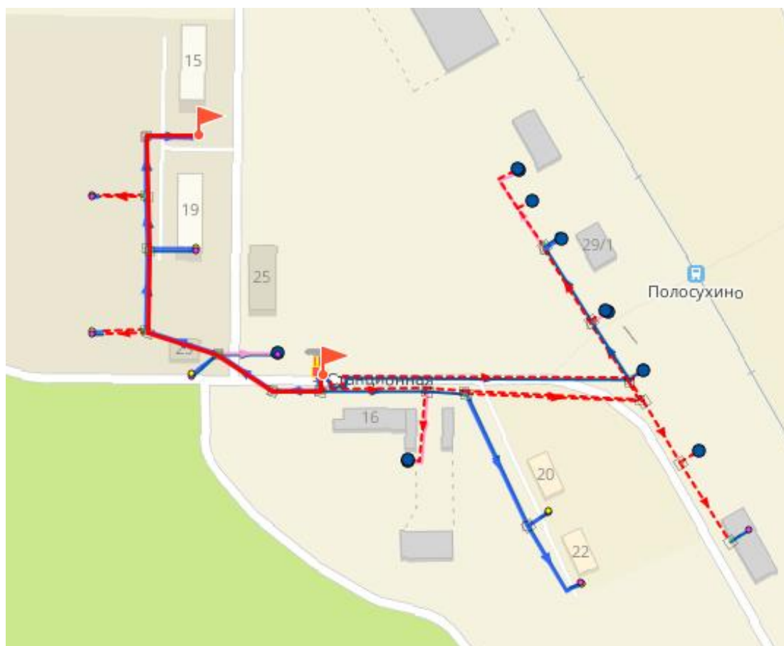
Рисунок 4.122 – Путь движения теплоносителя от источника тепловой энергии до конечного потребителя, в зоне действия котельной Полосухинская (рисунок П46.1 МУ)
