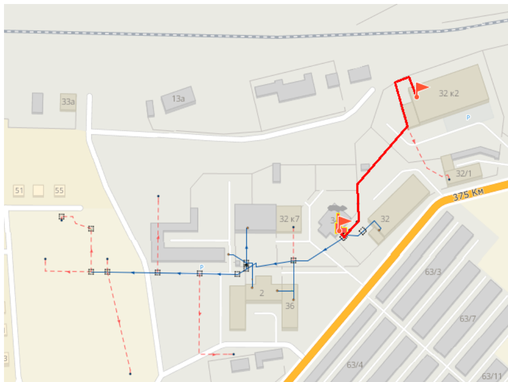
Рисунок 4.76 – Путь движения теплоносителя от источника тепловой энергии до конечного потребителя, в зоне действия котельной №6 (рисунок П46.1 МУ)
