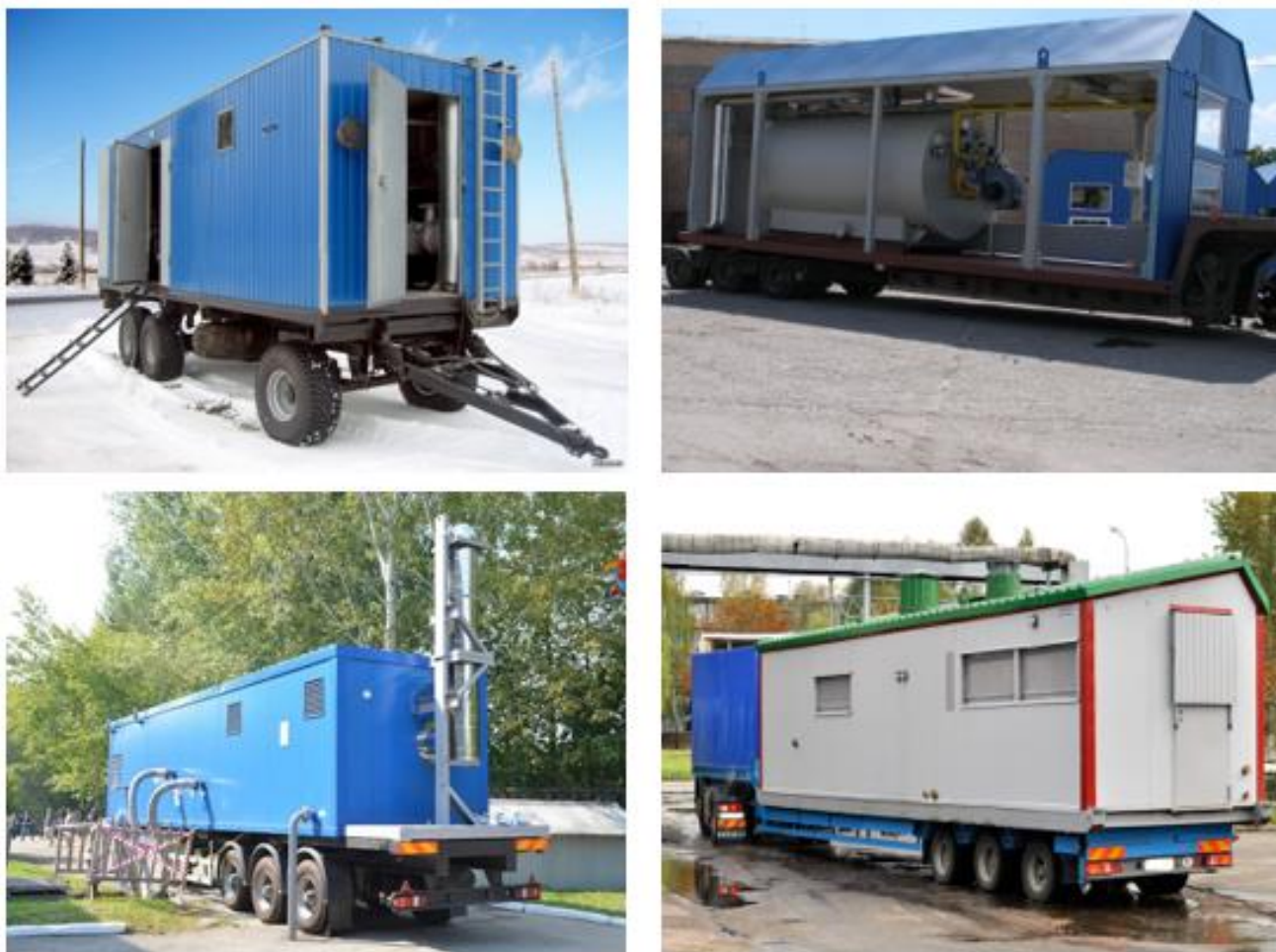
Рисунок 8.1 – Внешний вид передвижных котельных установок
