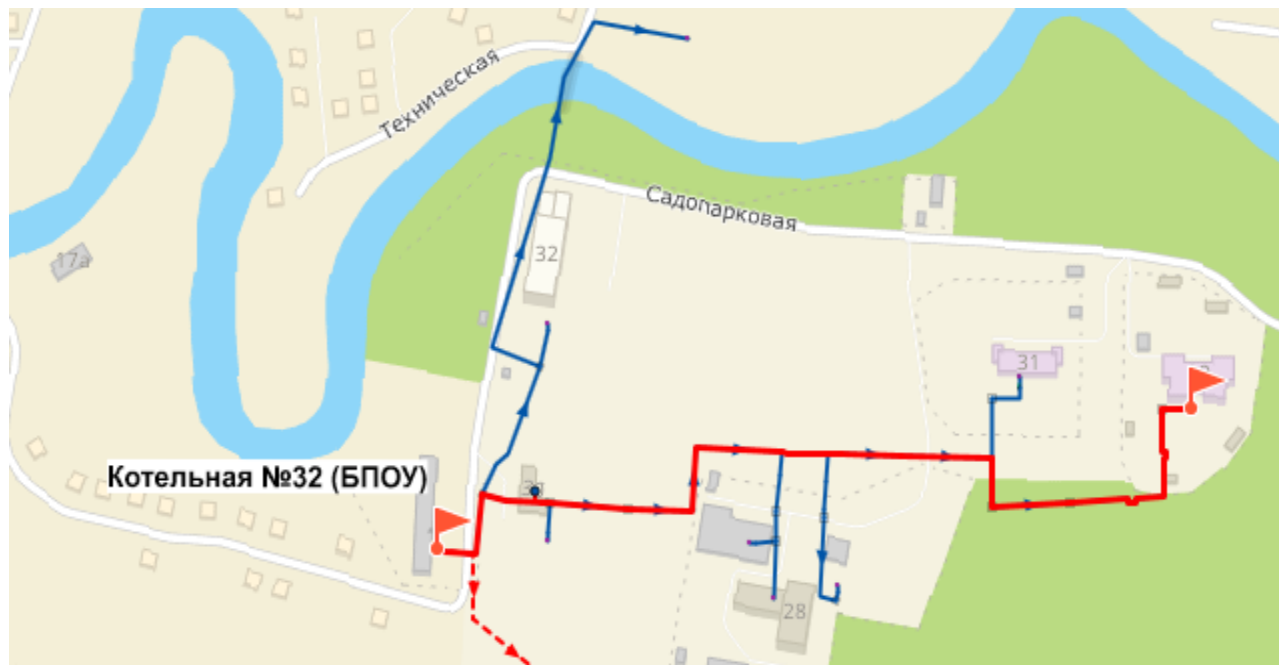
Рисунок 4.78 – Путь движения теплоносителя от источника тепловой энергии до конечного потребителя, в зоне действия котельной №32 (БПОУ) (рисунок П46.1 МУ)
