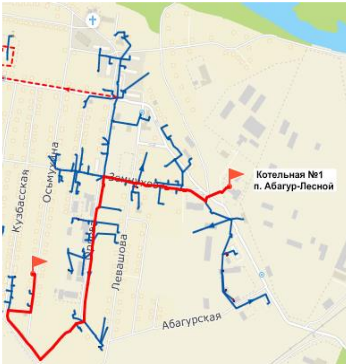
Рисунок 4.64 – Путь движения теплоносителя от источника тепловой энергии до конечного потребителя, в зоне действия котельной №1 п. Абагур-Лесной (рисунок П46.1 МУ)
