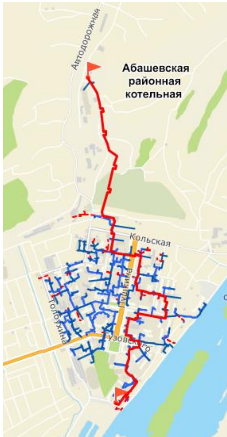
Рисунок 4.34 – Путь движения теплоносителя от источника тепловой энергии до конечного потребителя, в зоне действия Абашевской районной котельной (рисунок П46.1 МУ)
