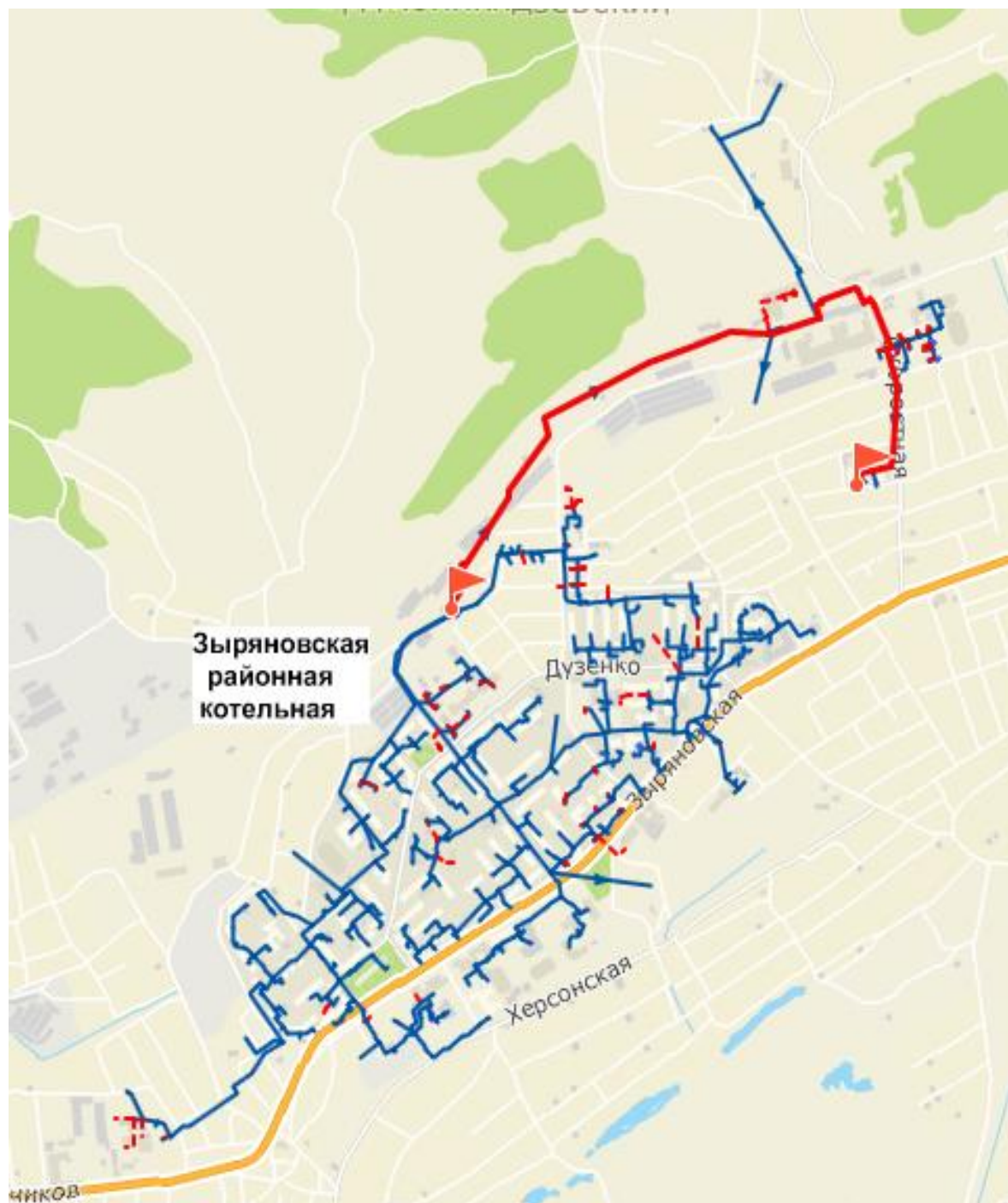
Рисунок 4.38 – Путь движения теплоносителя от источника тепловой энергии до конечного потребителя, в зоне действия Зырянской районной котельной (рисунок П46.1 МУ)
