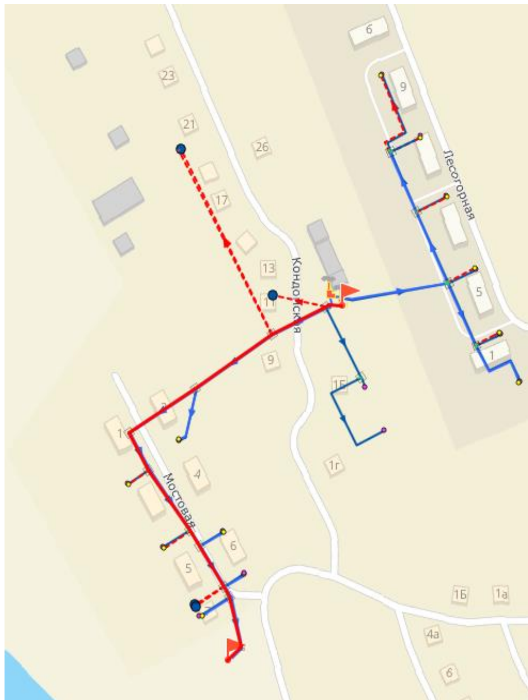
Рисунок 4.82 – Путь движения теплоносителя от источника тепловой энергии до конечного потребителя, в зоне действия котельной №1 п. Разъезд-Абагуровский (рисунок П46.1 МУ)
