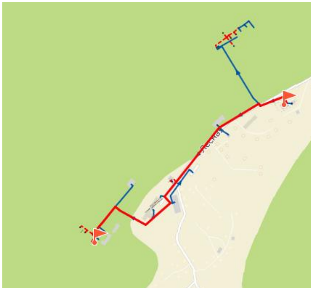
Рисунок 4.60 – Путь движения теплоносителя от источника тепловой энергии до конечного потребителя, в зоне действия котельной ОРК «Таргай» (рисунок П46.1 МУ)
