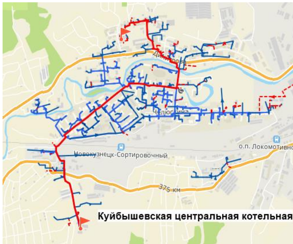
Рисунок 4.42 – Путь движения теплоносителя от источника тепловой энергии до конечного потребителя, в зоне действия Куйбышевская центральная котельная (рисунок П46.1 МУ)
