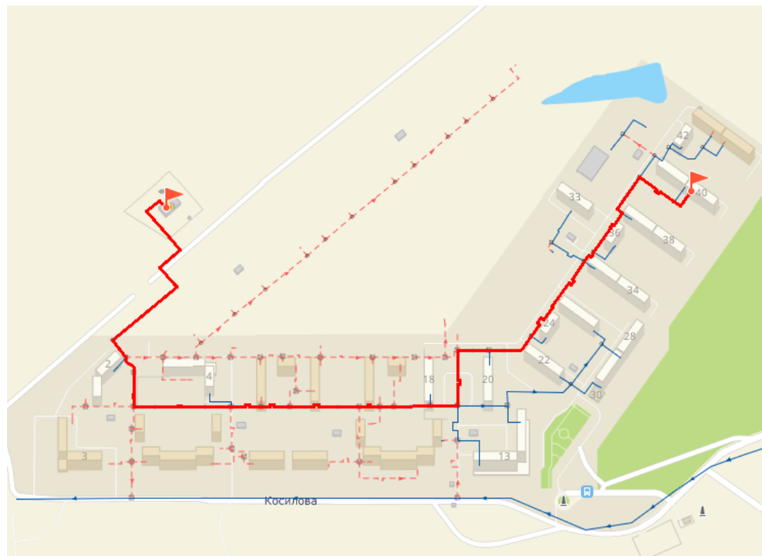
Рисунок 4.18 – Путь движения теплоносителя от источника тепловой энергии до конечного потребителя, в зоне действия Котельной кв. 24 (рисунок П46.1 МУ)
